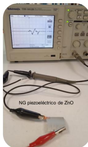
En la Figura 4 se observa un voltaje pico generado entre 0.2 y 0.6 V y un voltaje pico a pico máximo de 1.1 V, estos resultados son comparables a los presentados por otros investigadores (Justeau, et al., 2019; Rafique, et al., 2020).
