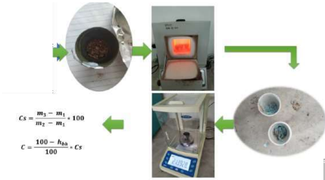
Figura 2. Esquema de la determinación de cenizas del cuesco de palma.
